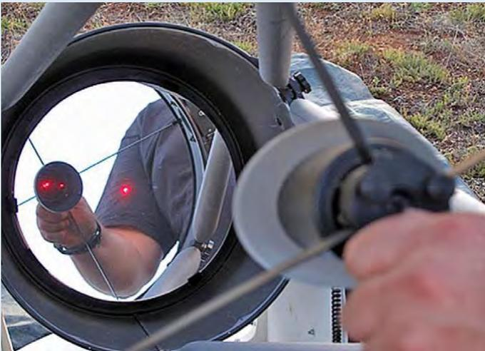
Si el telescopio es de tipo newton, también puede ocurrir un fenómeno de descolimación. La colimación de telescopios reflectores o Schmidt-Cassegrain consiste en asegurar que sus espejos están adecuadamente alineados para que la óptica no se vea negativamente afectada. Una descolimación grave podría aparentar ser un problema de enfoque. No afecta a telescopios refractores.
